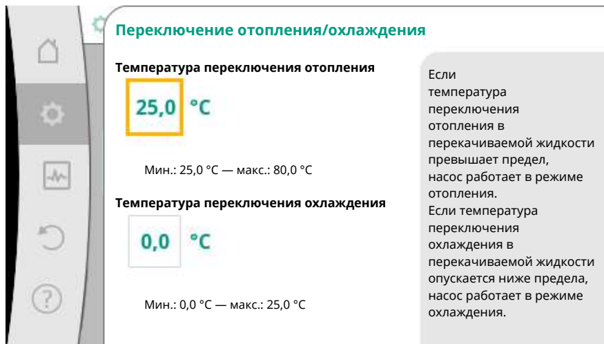
Fig. 57: Переключение отопления/охлаждения_Температуры переключения
