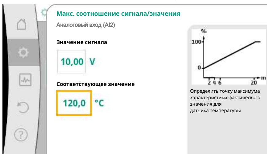
Fig. 81: Макс. соотношение сигнала/значения, датчик фактического значения
